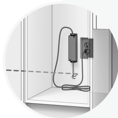
Transformateur intégré 120 VAC/12 VDC avec fil de 10 pieds pour connecter la niche
